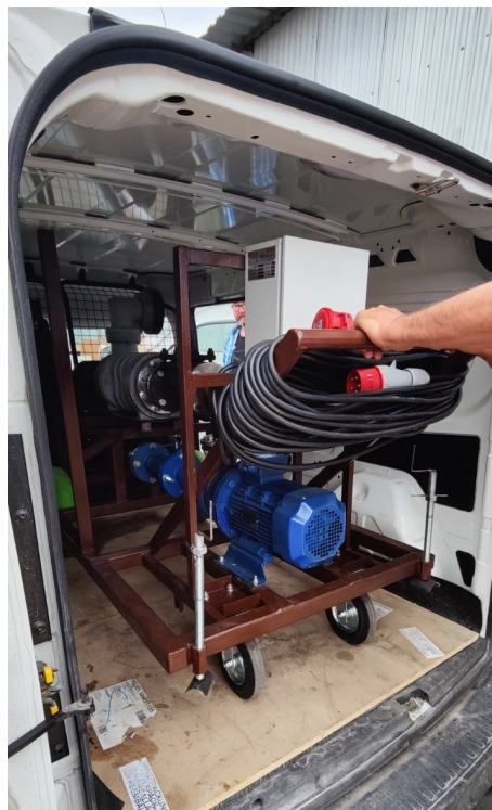
1 - Насос КМ 2 - Клапан зворотній Ду80, 3 - Фільтр сітчастий Ду100, 4 - Кран кульовий Ду100, 5 - Манометр контрольний, 6 - Кран кульовий Ду80 7 - Шафа керування насосом
